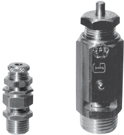
可调式安全阀，压力调节范围3~7bar。 通常安装在气罐上或其他应用场合，但使用压力不得超过额定值。
