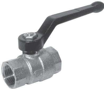
迷你型铜球阀，手动操作，长手柄。 轴向安装，可以打开或关闭气流的双向流动。
